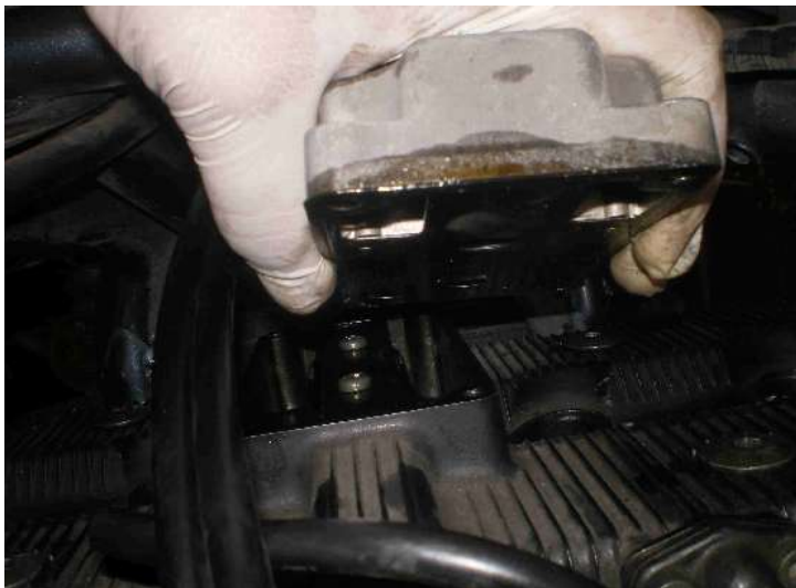
Rimontiamo il coperchio del serbatoio recupero olio...
