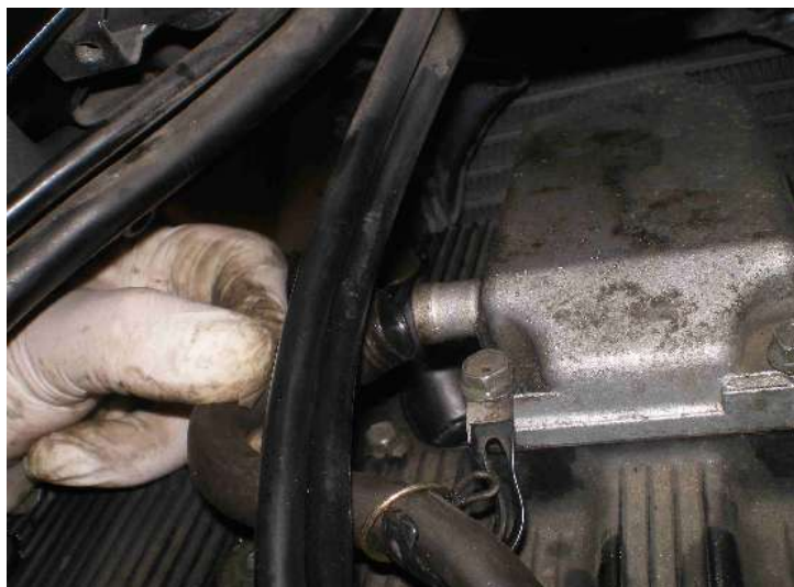
Riattacchiamo il tubo di gomma del serbatoio recupero olio e fissiamolo con la relativa fascetta metallica.
