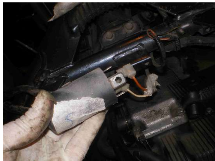
Rimontiamo anche le bobine ricordandoci di attaccare i connettori prima di fissarle definitivamente (diversamente risulterà estremamente difficile farlo in seguito)
